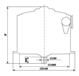
Рисунок 1. Габаритные, установочные и присоединительные размеры двигателей серии AB3-2
